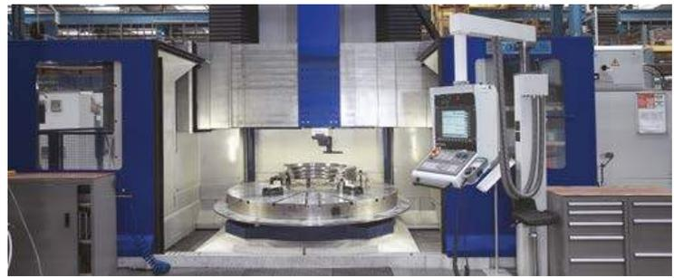
Platos 800 a 6.000 mm \* Diám. Máx. 7.300- Altura Máx 5.000 - 1-2 Ram – Sistema Twin Motor
